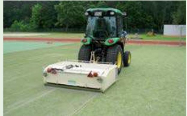
Durch eine rotierende Bürste wird das verschmutzte Füllmaterial aufgenommen, Feinanteile werden abgesaugt, Grobschmutz ausgesiebt.
